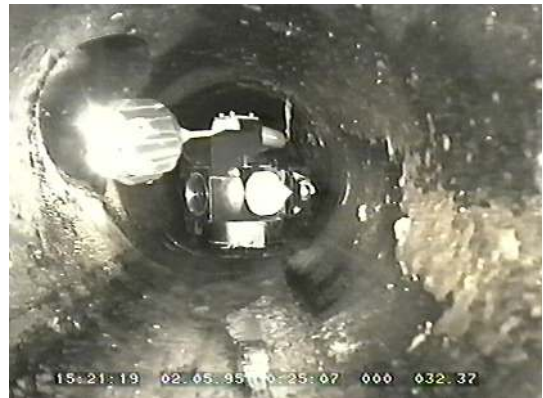
Szene aus dem Video: Die Satellitenkamera erreicht auch kleine, verwinkelte Rohre
