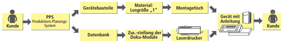
wird erst nach Auftragseingang montiert, während der Montage wird eine PDF-Datei mit der Dokumentation gedruckt. Wenn die Waage fertig montiert ist, liegt auch die zugehörige Dokumentation im Drucker.
