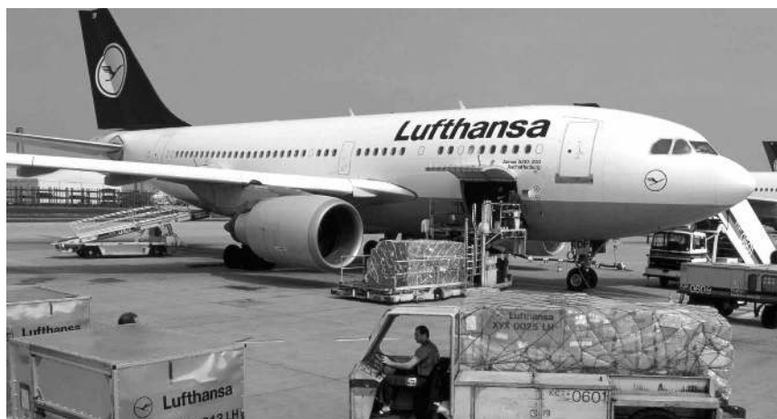
Verladung von Fracht in den Unterflurfrachtraum eines Großraum-Passagierflugzeuges (Airbus A310-300) der Lufthansa: Jeder Handgriff muss hier sitzen. Foto: W. Krüger/Lufthansa
